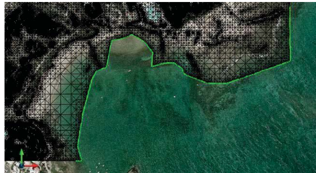
Figura 23. Ej. de condición de salida (calado=0m)
